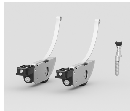
Нижні роликові механізми, що запобігають розкачуванню полотна та направляючий роликовий штифт (навантаження дверного полотна йде на верхні ролики)
